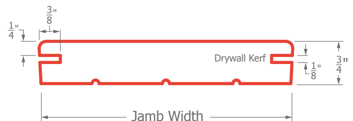
Kerf for Drywall
